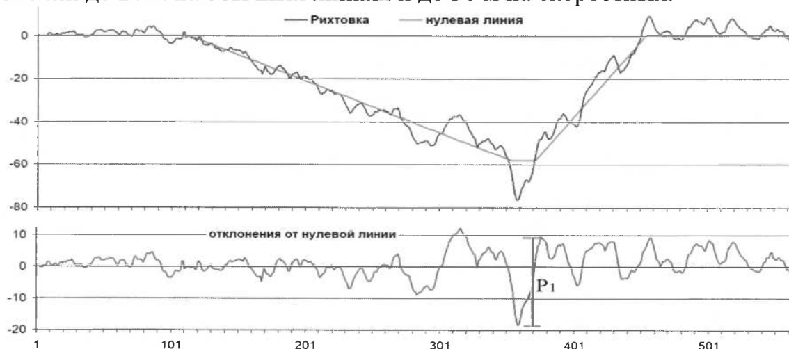
Рис. П.1.8. Пример отступления по рихтовке, величиной 28 мм и длиной 30 м
