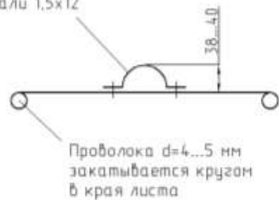
Поясок из полосовой стали 1,5x12
