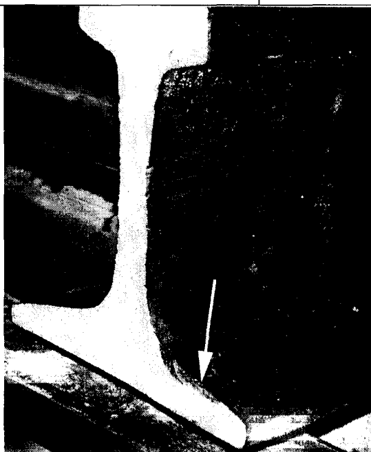
Дефект 66.3. Вид излома после вскрытия дефекта. Стрелкой показан дефект - трещина от раковины в сварном шве
